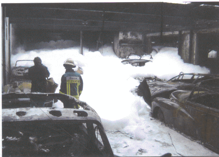
Der raumfüllende, noch fließfähige Schaum füllt Bereiche, die von anderen Löschmitteln nicht erreicht werden können.
